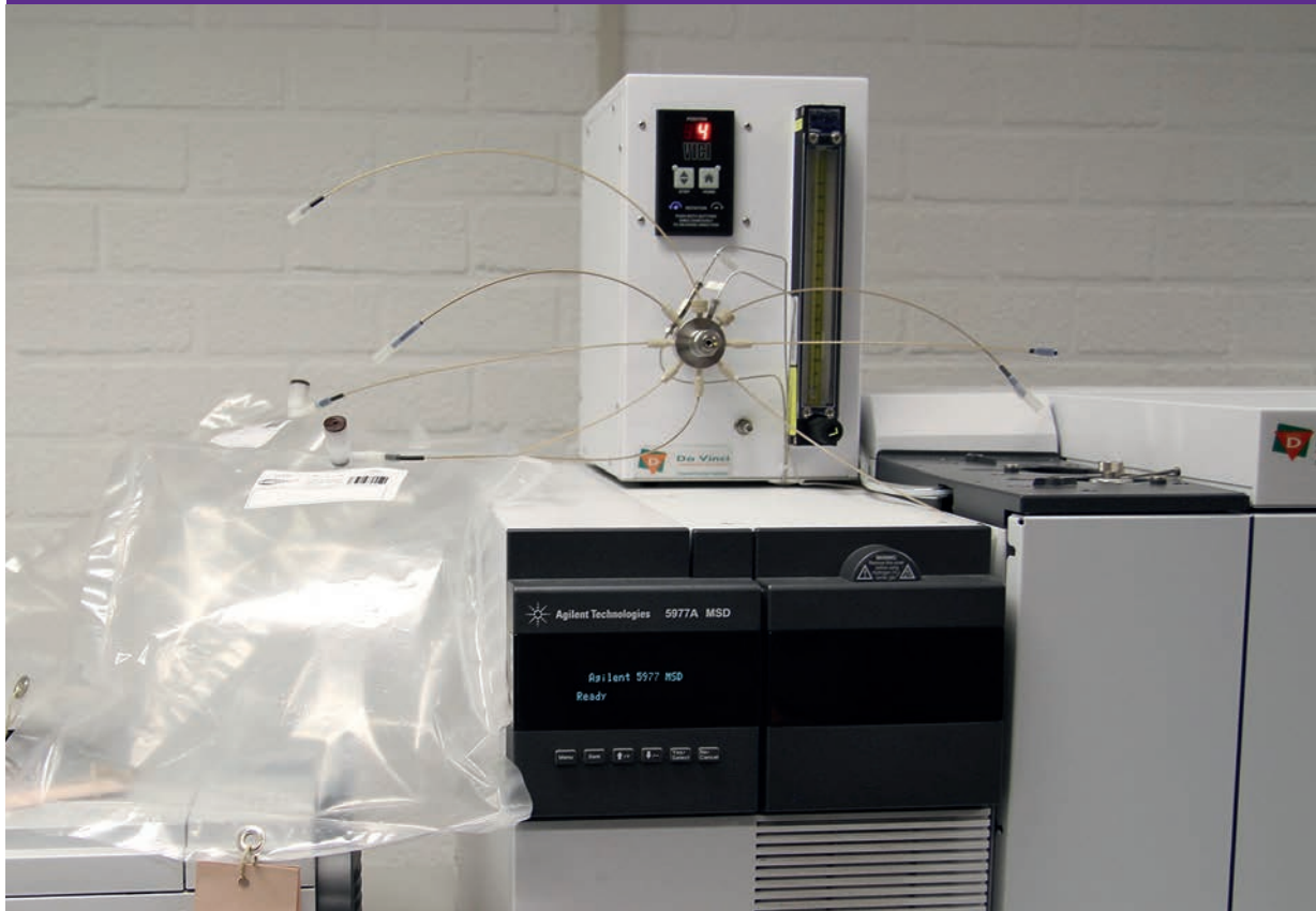
Het A2MA luchtbemonsteringssysteem bestaat uit een 8-poort multipositie valve en een 2-weg 6-poort rotor valve van VICI, drie 2/3-valves, een flow controller en een pomp. In deze configuratie maakt je altijd gebruik van dezelfde thermische desorptiebuis, die bovendien in een verticale stand staat. Links enkele Tedlar bag's waarmee offline luchtmonsters kunnen worden genomen.
