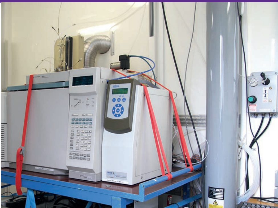
Het GC/MS-systeem in de meetwagen staat stevig vastgesjord als de wagen rijdt. De kunststof buis rechts bevat het aanvoerkanaal van de tien meter hoge meetmast die op de meetlocatie wordt opgepompt.
