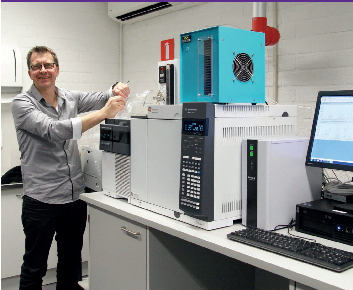
John Maurits bij het door Da Vinci Laboratory Solutions geleverde GC/MS-systeem dat is uitgerust met het Automatic Air Monitoring Analyzer luchtbemonsteringssysteem.
